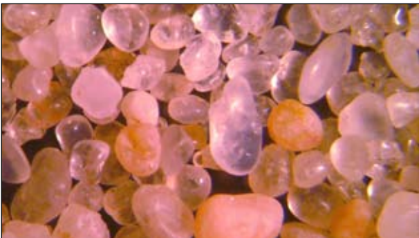
Рисунок 3.8. Обогащенные кварцевые пески Секеринского месторождения (увел. 20)
